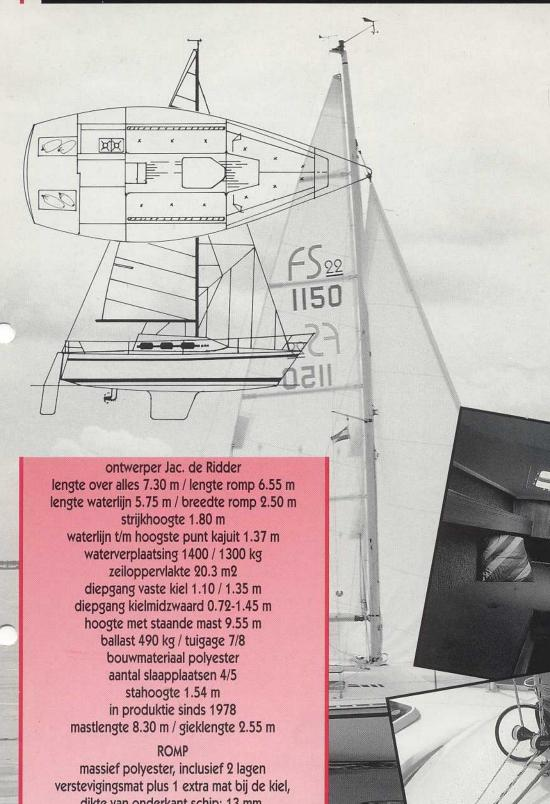
dikte van onderkant schip: 13 mm, dikte van de zijkant van de romp: 8 mm.
