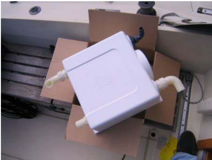
Tank voor montage. Alle wartels al gemonteerd.
